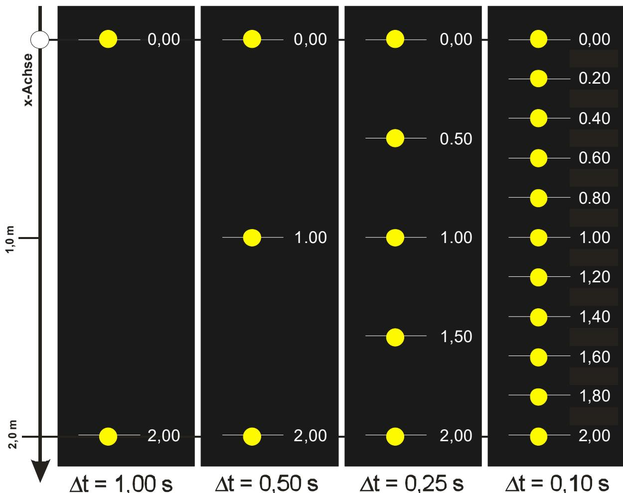
Der Ball legt in diesem Versuch innerhalb einer Zeitspanne von  $\Delta t=1,00 \text{ s}$  eine Strecke von  $\Delta x=2,00 \text{ m}$  zurück. Je kürzer  $\Delta t$  ist, desto häufiger wird der rollende Ball auf einem Bild abgelichtet [siehe Abbildungen oben; Die Zahlen rechts von den Bällen geben jeweils die zum Belichtungszeitpunkt  $t$  den aktuellen Ortspunkt  $x(t)$  in Meter (m) an].
