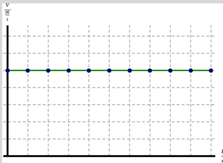
Der Zusammenhang zwischen der Zeit  $t$  und der Geschwindigkeit  $v$  ist mit  $2,0 \text{ m/s}$  **konstant**, der Graph verläuft parallel zur  $t$ -Achse, also horizontal.
